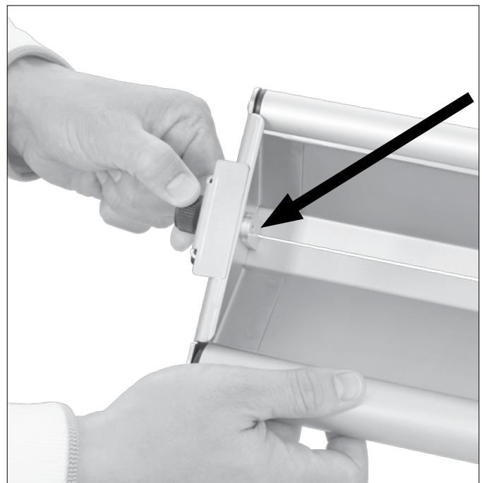
Inserire e premere il taglierino a rotella nel dispositivo di serraggio del carrello di taglio. Dopodiché serrare il dispositivo di serraggio con la vite laterale e abbassare il chia-vistello agendo sull'impugnatura.
