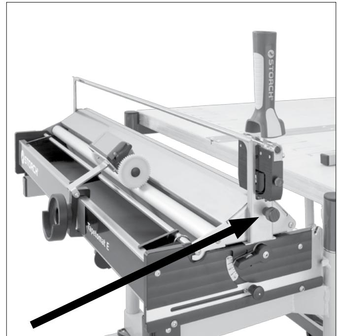
Befestigungsmuttern auf der Innenseite der Haube mit den schwarzen Schrauben fixieren, Schneidwagen ausrichten und Schrauben festziehen.
