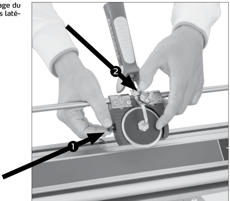
Déplacer le chariot avec la lame circulaire au centre du bâti, tirer légèrement vers le haut et insérer la lame dans la fente de coupe.
