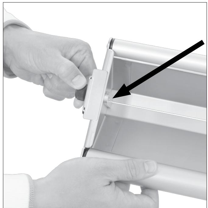
Kolečkový nůž vložte do svěrného upevnění u vozíku k řezání tapet a vtlačením jej upevněte. Potom svěrné upevnění dotáhněte postranním šroubem a sklopte dolů zástrčku u držadla.
