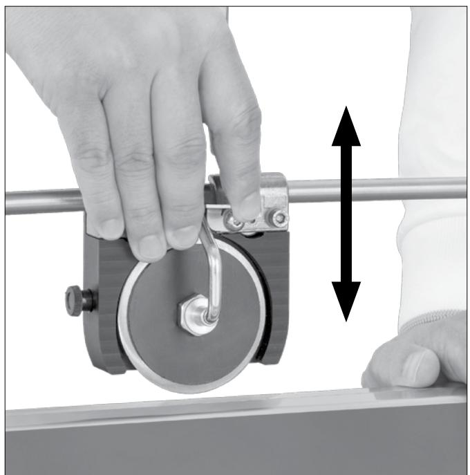
Kryt opět nasaděte na přístroj a nožem jedle do parkovací polohy na straně.
