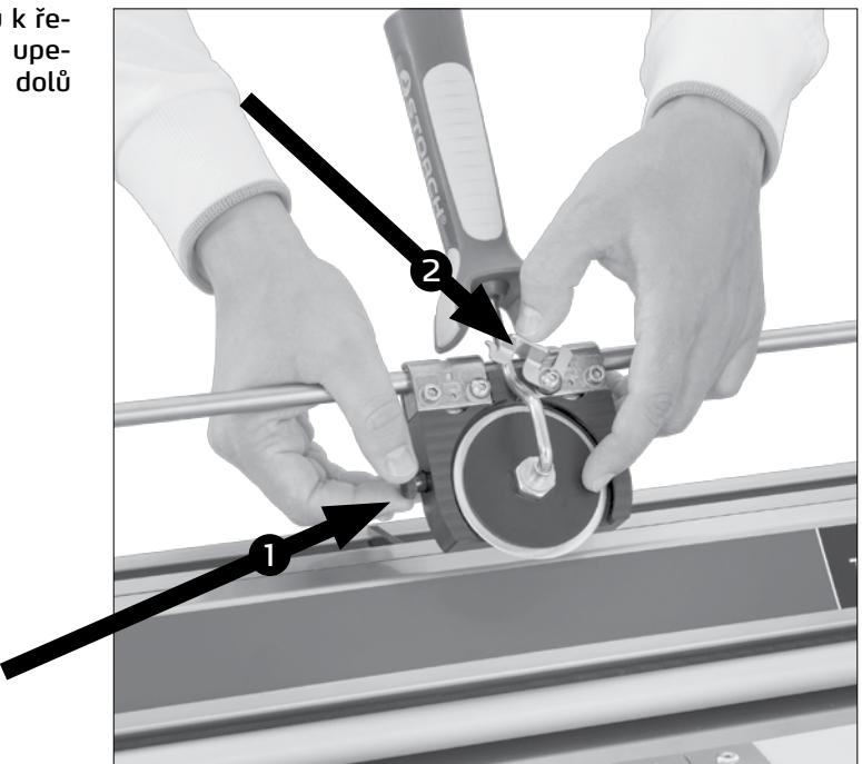
Vozíkem s kolečkovým nožem najedte na střed podstavce, lehce zatáhněte směrem nahoru a nůž vsaďte do řezné štěrbiny.
