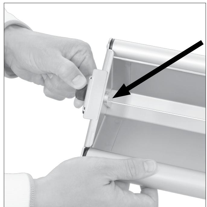
Das Rollmesser in die Klemmung des Schneidwagens einlegen und andrücken. Dann Klemmung mit der seitlichen Schraube anziehen und den Riegel am Griff herunterklappen.
