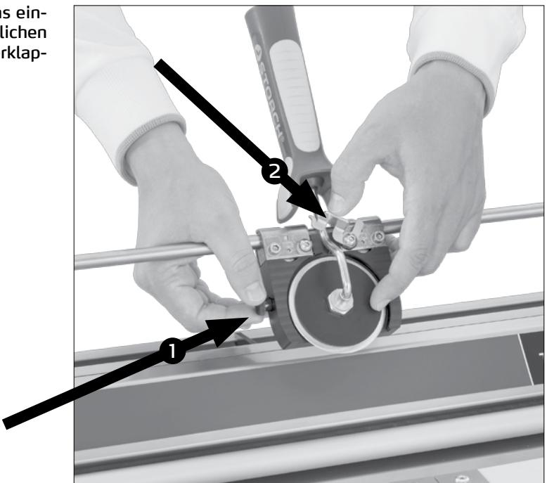
Den Wagen mit dem Rollmesser in die Mitte des Gestells fahren, leicht nach oben ziehen und das Messer in den Schneidschlitz einsetzen.
