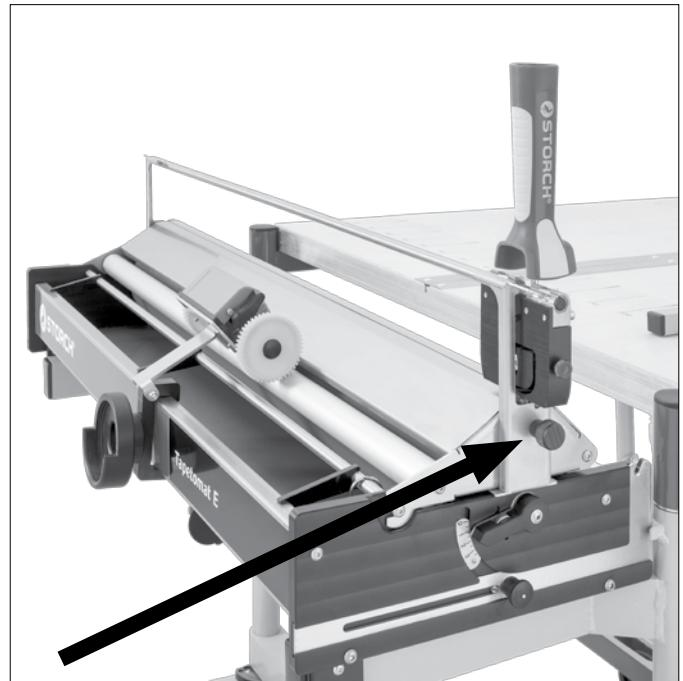
Fissare i dadi di fissaggio sul lato interno della calotta con le viti nere, allineare il carrello di taglio e fissare le viti.
