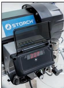
Visualizzazione sul display a LED nel modello ST 900 e ST 1700/1700
